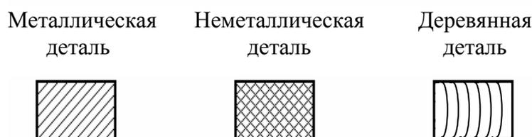
Рис. 6.8. Виды штриховки разрезов и сечений
