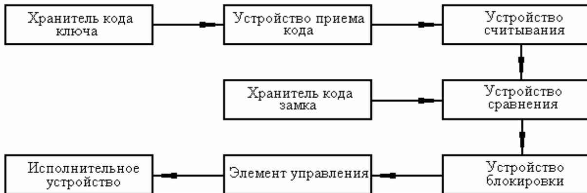
Рис. 4.3. Схема механического замка на информационно-логическом уровне
