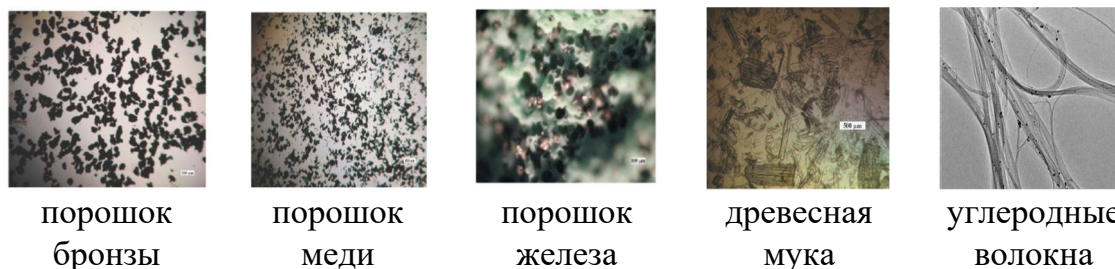
Рис. 3.69. Структура композитных наполнителей PLA-пластика
