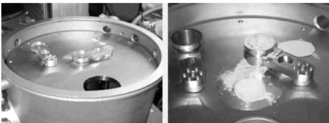
Рис. 3.34. Фотографии системы нанесения слоев порошка в технологии Laser Micro Sintering
