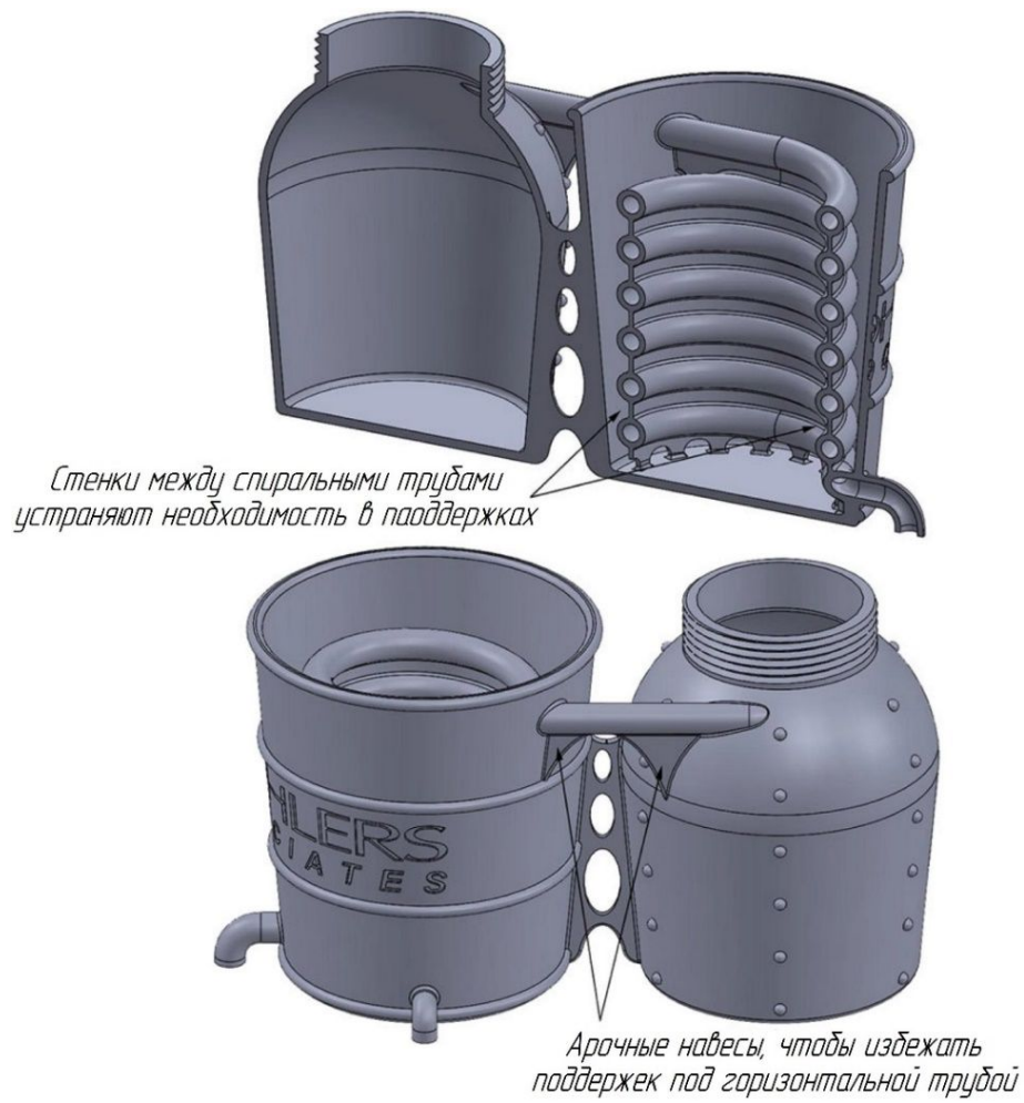
Рис. 5.20. Использование стен, чтобы избежать необходимости в «поддержках»
