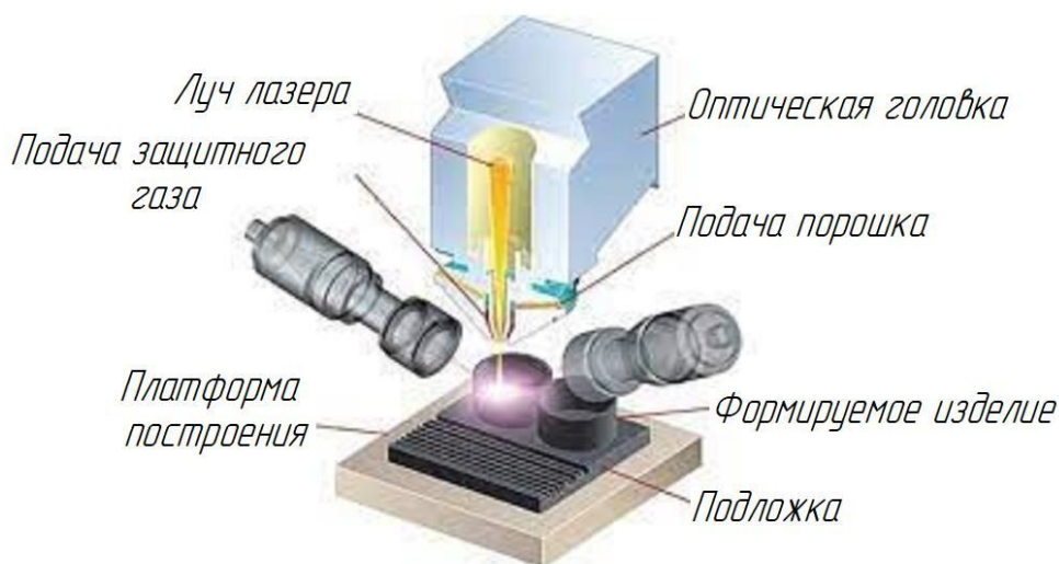
Рис. 3.90. Схема установки послойной лазерной наплавки DMD®
