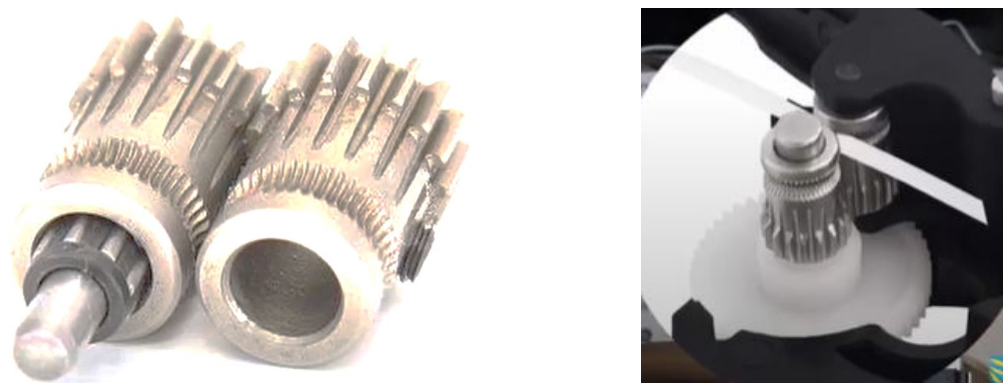
Рис. 3.57. Механизм подачи пластика с двумя шестернями
