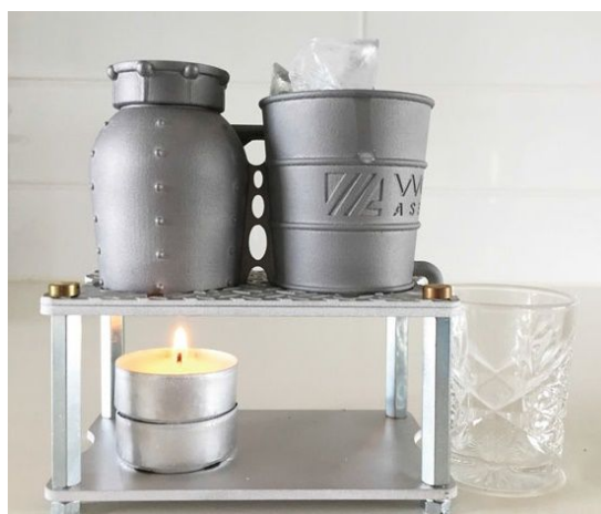
Рис. 5.19. Алюминиевая настольная винокурня, изготовленная с использованием аддитивных технологий
