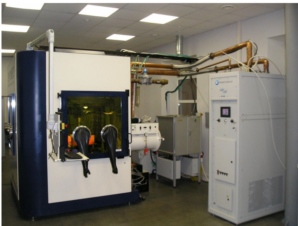
Рис. 3.89. Внешний вид установки LENS™ 850 R
