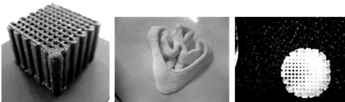
Рис. 3.76. Изделия, полученные на установке 3D-Bioplotter™ («EnvisionTEC GmbH», Германия)
