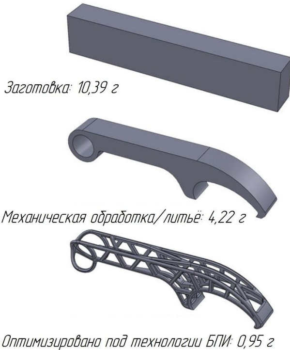
Рис. 5.22. Пример снижения массы изделия «ключ-откупорка для бутылок» за счет ОТ для изготовления технологиями БПИ
