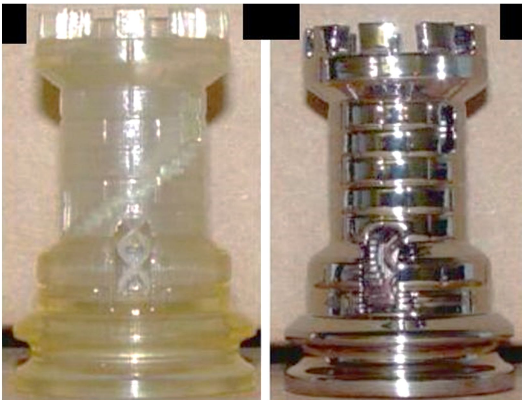
Рис. 3.4. Изделие, полученное стереолитографией до постобработки и после постобработки гальванопластикой
