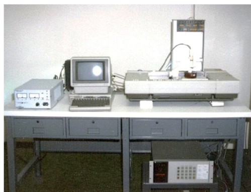
Рис. 1.11. Внешний вид установки аддитивного производства SLA-1
