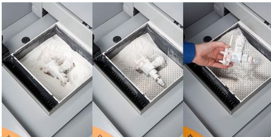
Рис. 3.80. Извлечение готовой модели из аппарата ZPrinter® 450
