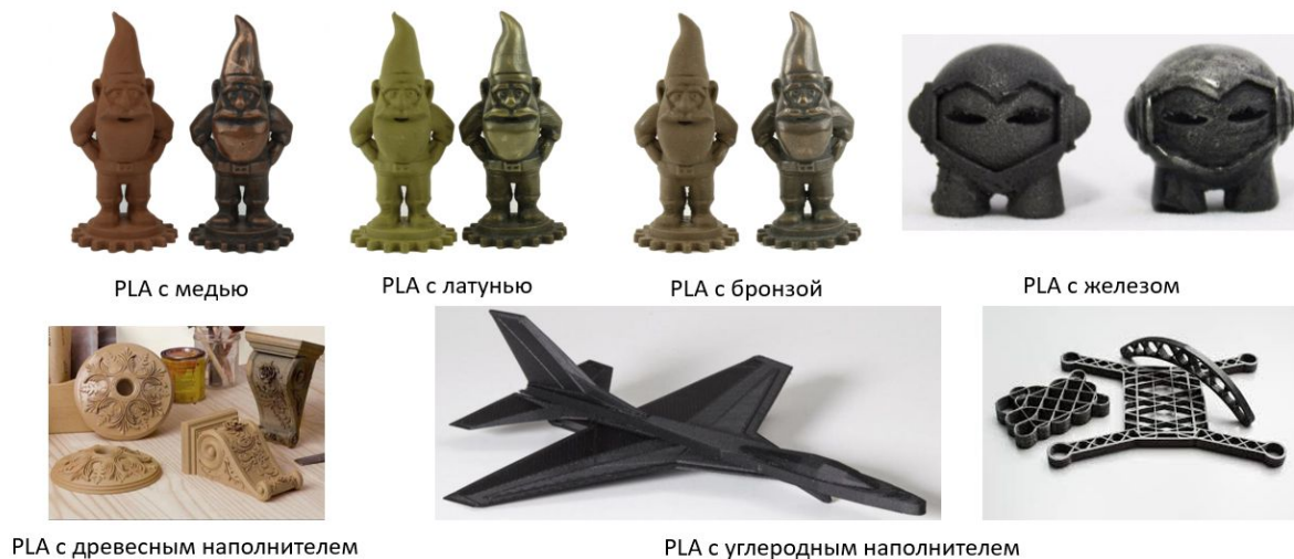
Рис. 3.70. Примеры изделий из композитных материалов на основе PLA-пластика
