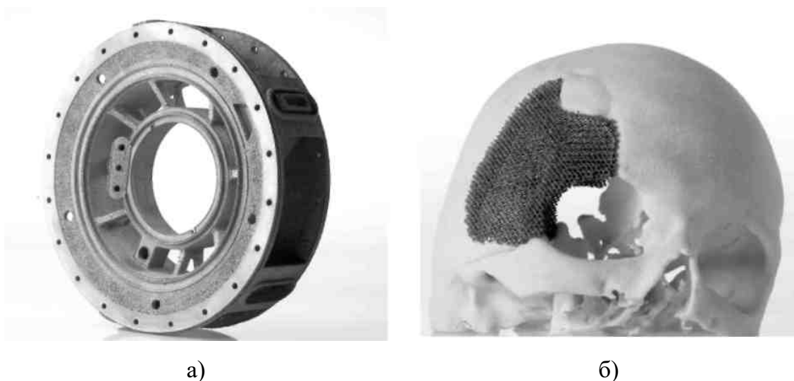
Рис. 3.28. Изделия, изготовленные электронно-пучковым плавлением: а – изделие аэрокосмической отрасли; б – индивидуальный имплантат
