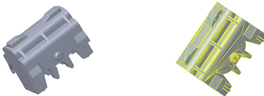
Рис. 4.1. Поверхностное (слева) и триангулированное (справа) представление трехмерной модели (ПО Creo Parametric, «Parametric Technology Corporation (PTC)» США)
