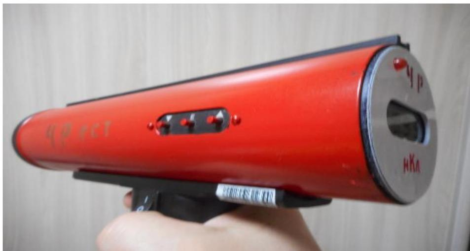
Рис. 4.9. Переносной прибор ЧР РСТ на базе антенны ООО DIMRUS
