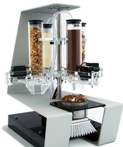
Рис. 1.45. пищевой 3D-принтер карусельного вида
