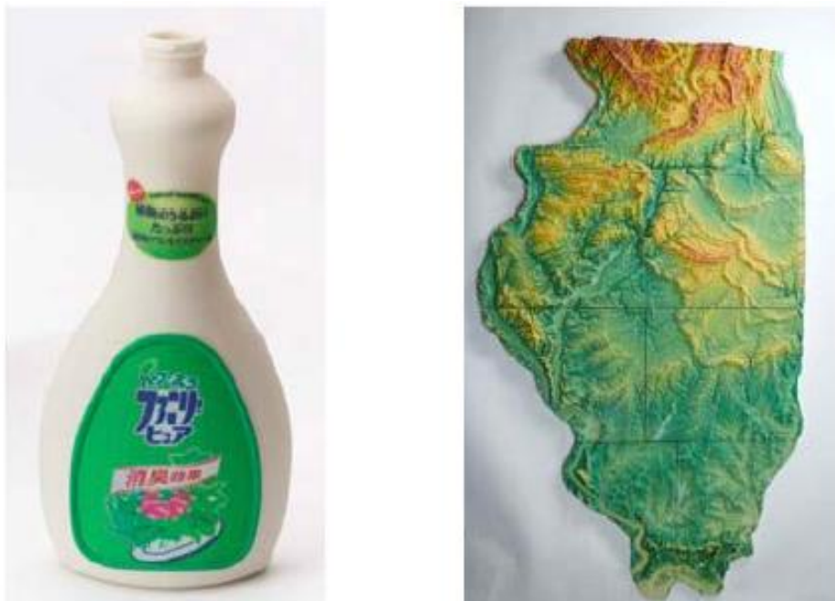
Рис. 1.27. Макеты, изготовленные с помощью струйной печати
