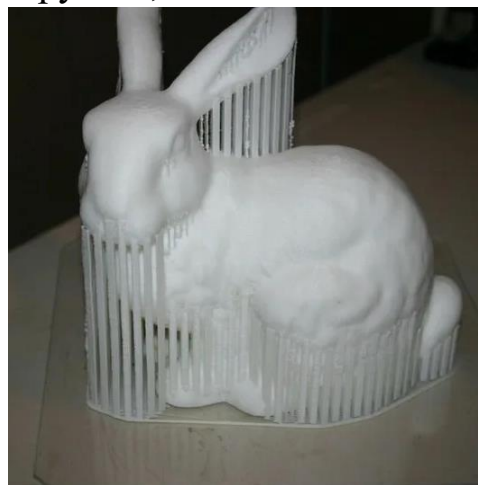
Рис. 1.5. Поддержки при печати
