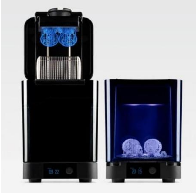
Рис. 1.21. Обработка после печати
