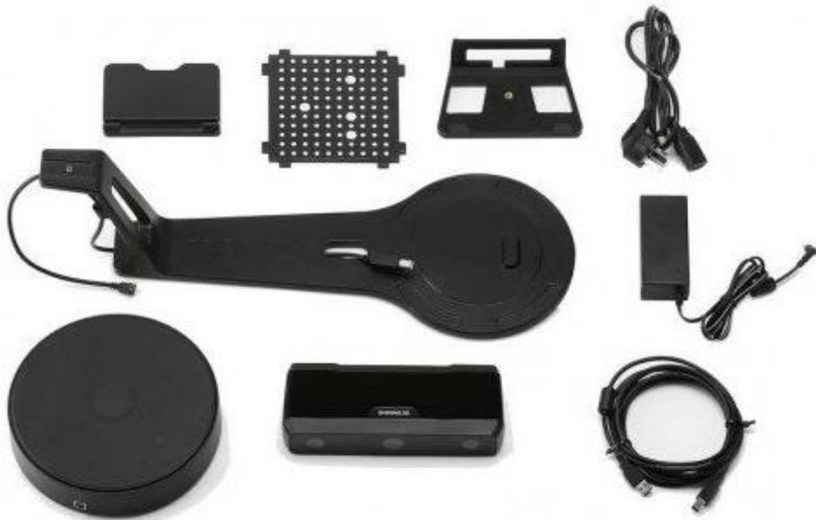
Рис. 3.4. Комплект 3D-сканера Shining einscan
