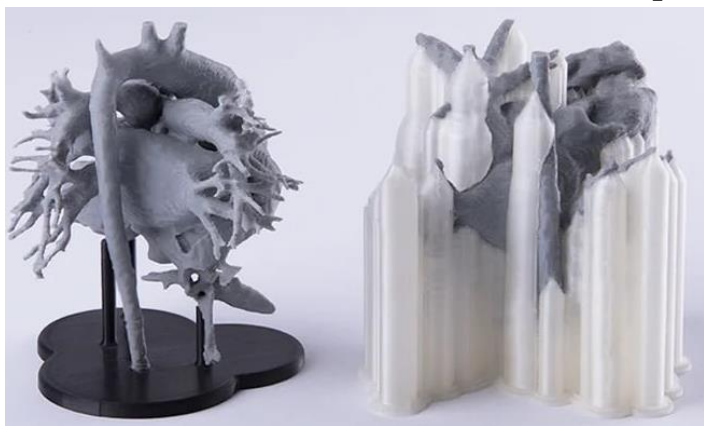
Рис. 2.20. Поддержки при печати сложных фигур
