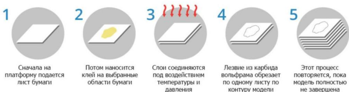
Рис. 1.30. Процесс печати методом селективного осаждения
