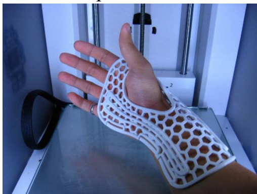
Рис. 1.6. Печать протеза на 3D-принтере
