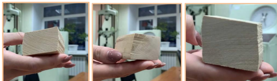
Рисунок 7 – Образцы после испытаний при нагружении поперек волокон: (слева направо) липа, береза, вяз
