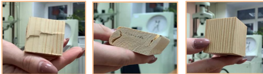
Рисунок 6 – Образцы после испытаний при нагружении вдоль волокон: (слева направо) сосна, осина, лиственница
