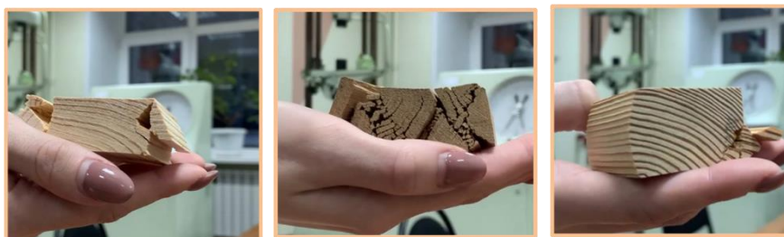
Рисунок 8 – Образцы после испытаний при нагружении поперек волокон: (слева направо) сосна, осина, лиственница
