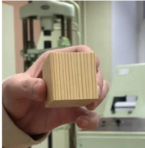
Рисунок 1 – Образец для испытаний (это лиственница)
