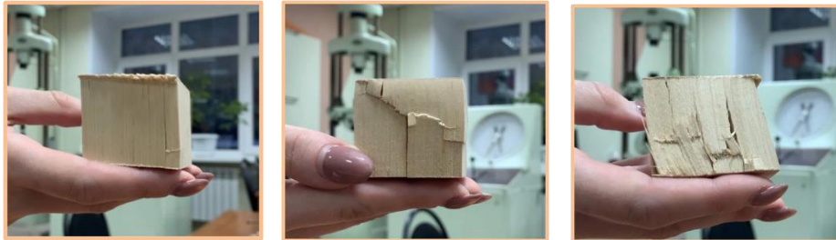
Рисунок 5 – Образцы после испытаний при нагружении вдоль волокон: (слева направо) липа, береза, вяз
