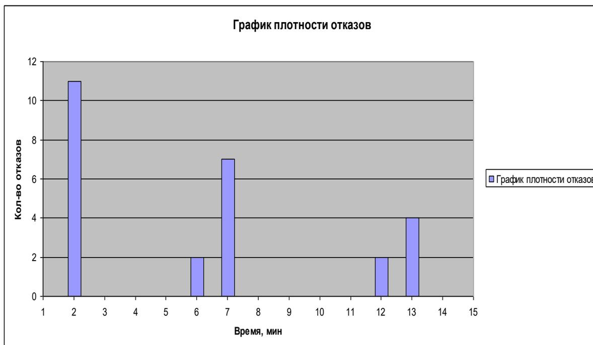
Рисунок 2.1.39 – График плотности отказов в эксперименте с ИМ-сервером
