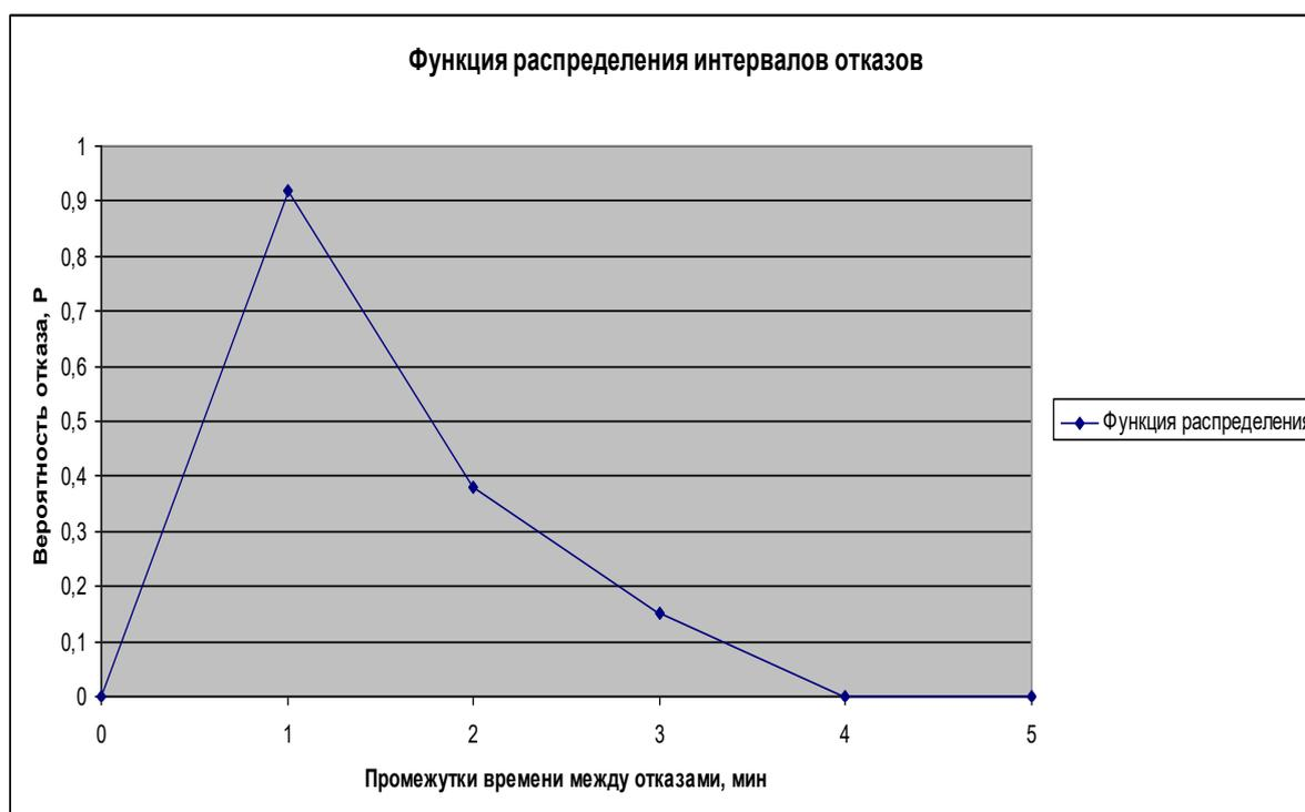
Рисунок 2.1.24 – Функция распределения интервалов отказов в эксперименте с FTP-сервером
