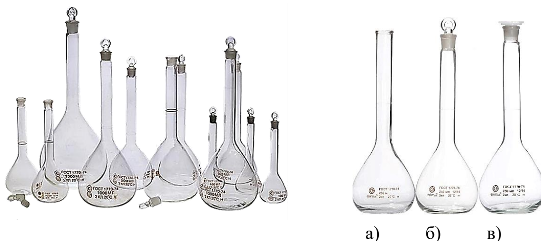
Рис. 53. Мерных колбы: классическая (а), со шлифованной горловиной и стеклянной пробкой(б), с пластиковой пробкой (в)
