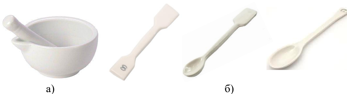
Рис. 47. Фарфоровые ступки с пестиком (а) и ложки-шпатели (б)
