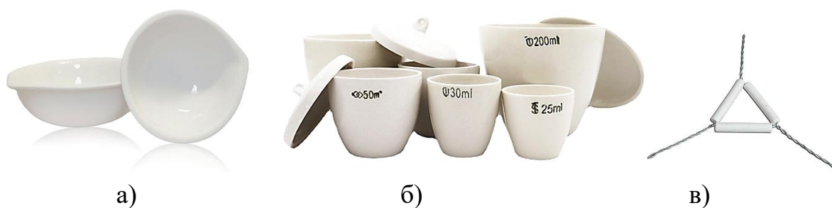
Рис. 46. Фарфоровые выпарительные чашки (а) и тигли (б)
