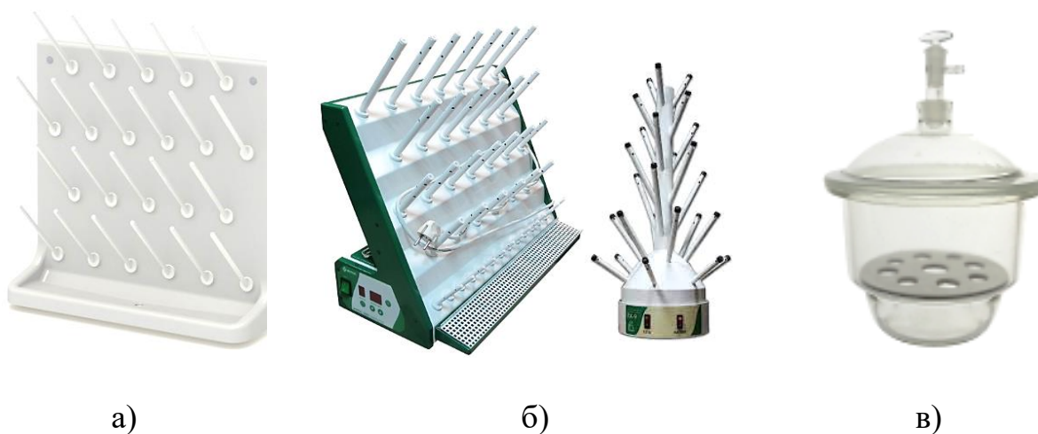
Рис. 73. Сушка лабораторной посуды естественным путем (а), потоками теплого воздуха (б), в эксикаторе (в)
