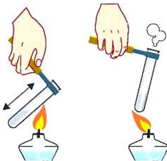
Рис. 11. Правильное нагревание пробирки
