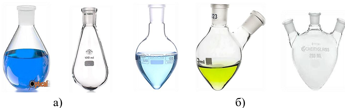
Рис. 21. Грушевидные (а) и остродонные колбы (б)
