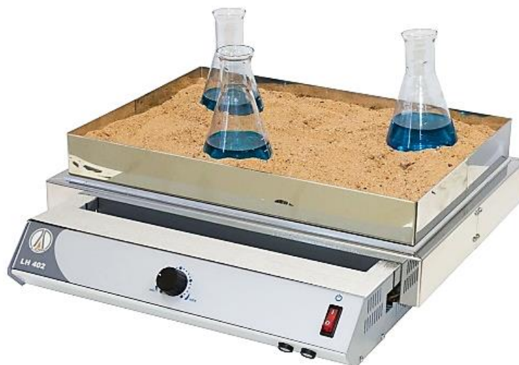
Рис. 80. Песочная баня для нагревания до высоких температур
