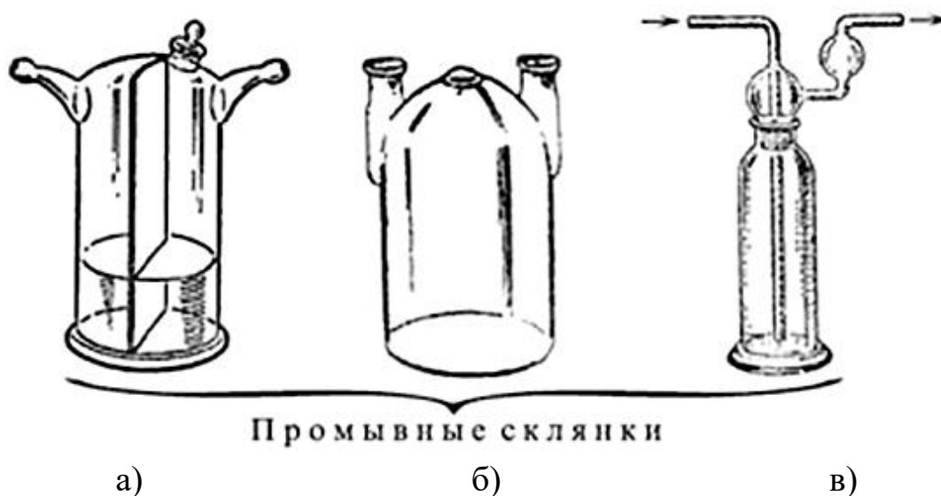
Рис. 35. Промывные склянки Тищенко (а), Вульфа (б) и Дрекслея (в)
