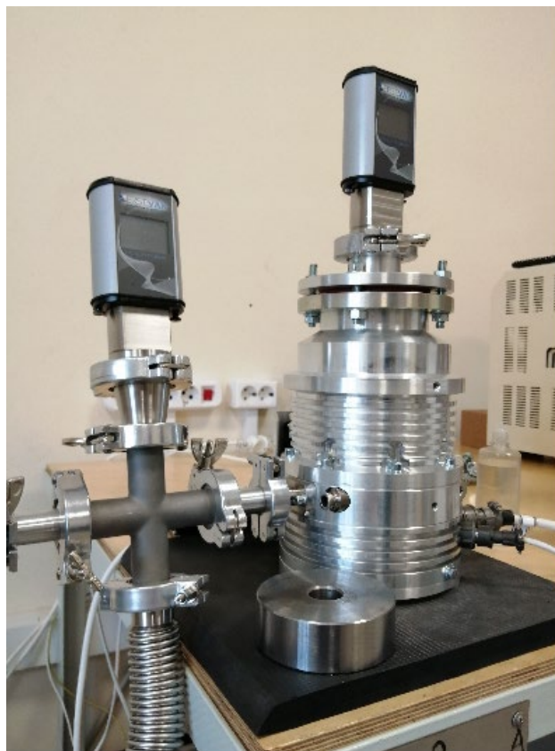
Рис. 91. Комплекс вакуумный турбомолекулярный КВТ-050 (Владимирский центр механической обработки – ВЦМО г. Владимир) [ https://vcmo33.ru/pumps/kvt-151 ]
