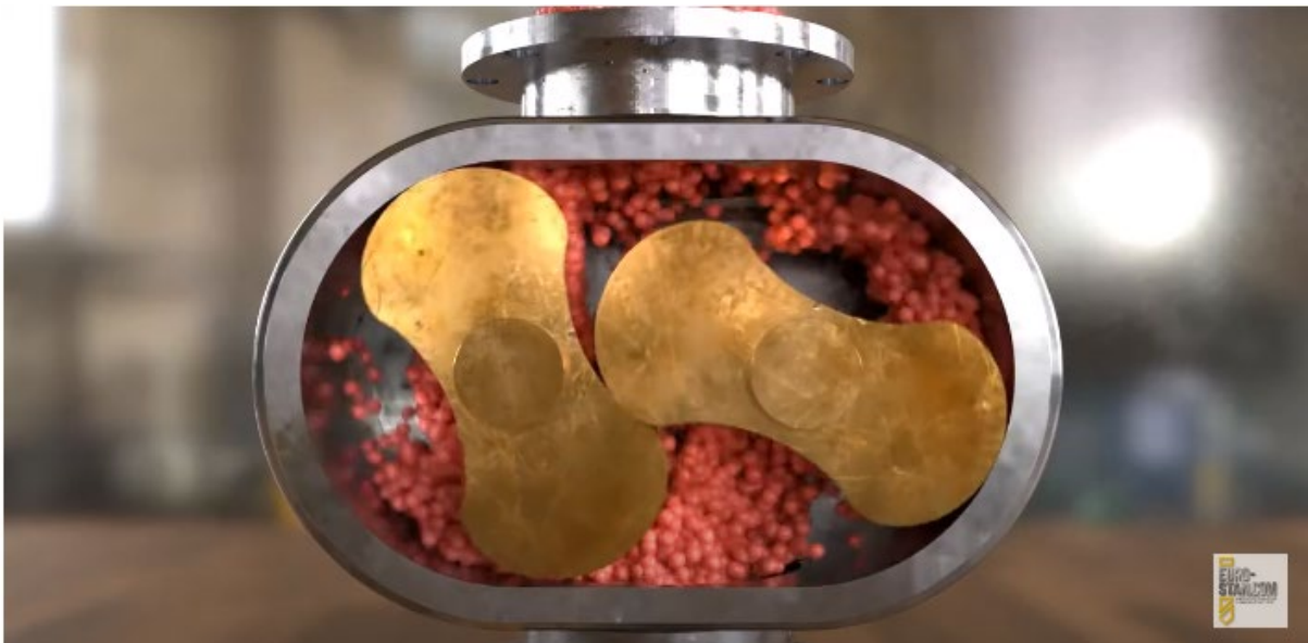
Откройте в папке Animation файл: Медиа 4. Принцип работы двухлопастного нагнетателя Рутса
