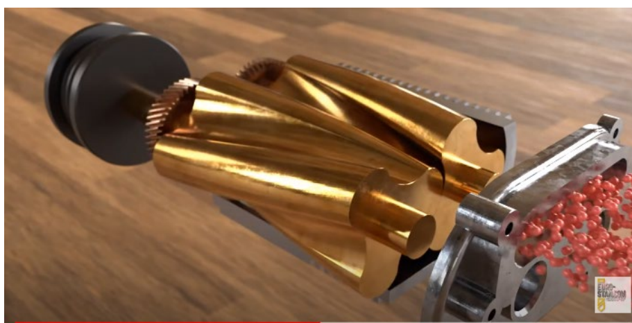
Откройте в папке Animation файл: Медиа 7. Принцип работы компрессора типа Рутса
