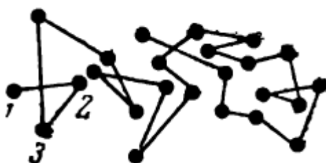
Рис. 13. Проекция на плоскость пути одной молекулы идеального газа в объёме. Начальное положение и следующие позиции отмечены цифрами [5, с. 37]
