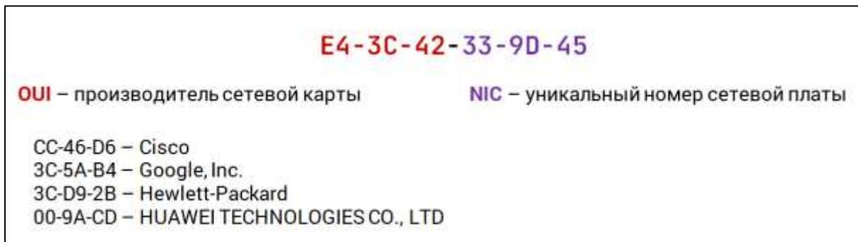
Рис. 1.16. Структура MAC-адреса и коды некоторых производителей сетевого оборудования
