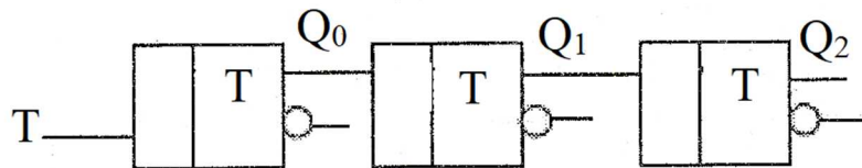
Рис. 2.19. Схема двоичного счетчика на T -триггере [8]
