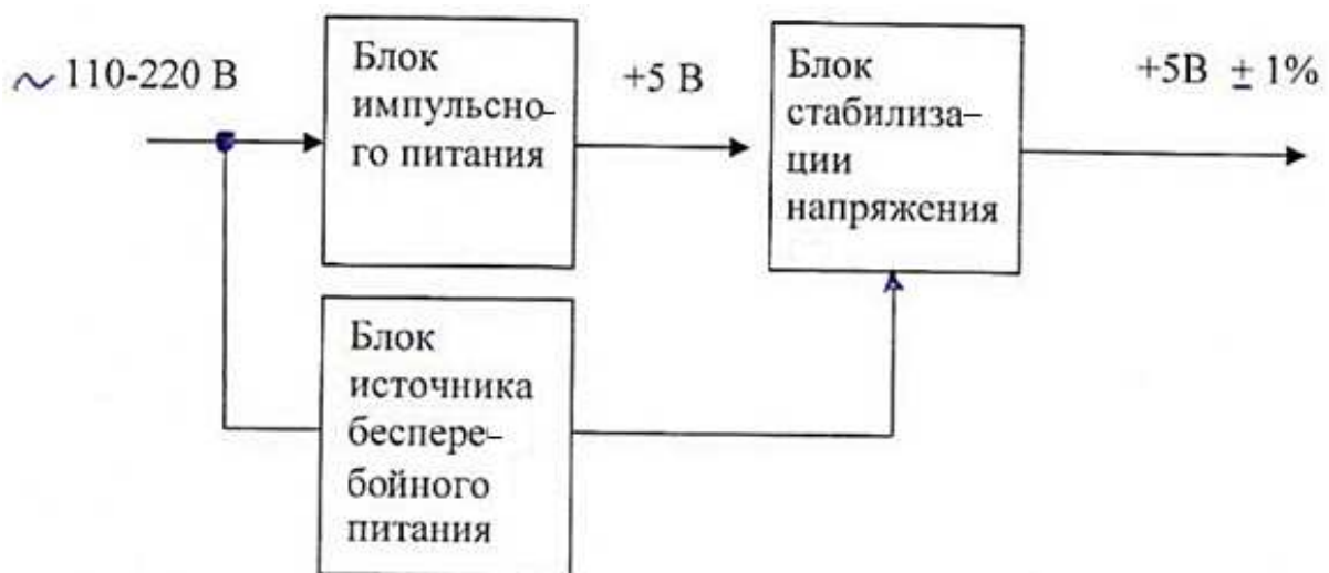
Рис. 1.1. Структурная электрическая схема блока питания
