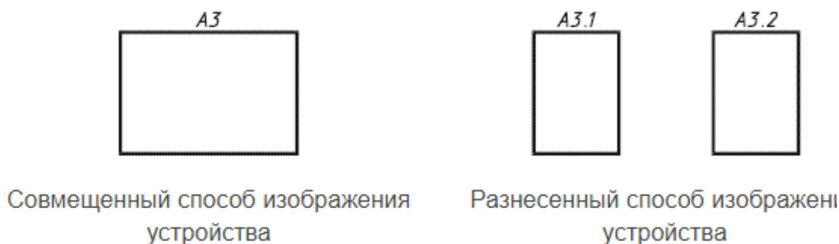
Рис. 1. Способы изображения и позиционного обозначения устройств
