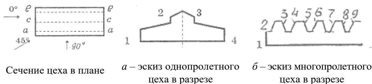
Рис. 17. Значение аэродинамических ветровых коэффициентов  $k$
