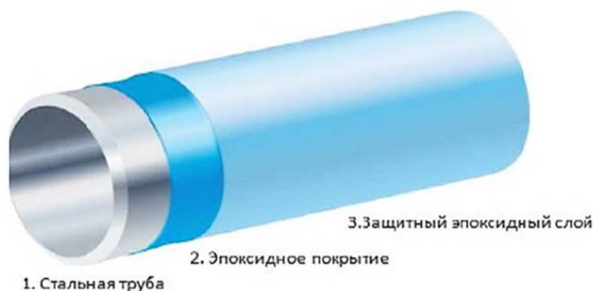
Рис. 6.7. Исполнение изоляции на основе двухслойного эпоксидного покрытия
