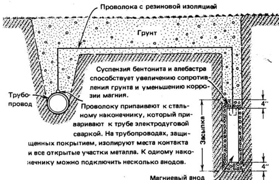
Рис. 7.3. Схема станции катодной защиты
