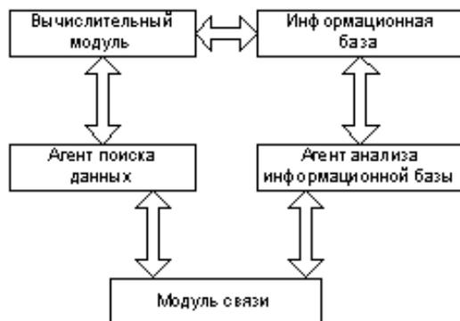
Рис. 1. Структурная схема узла распределенной вычислительной системы
