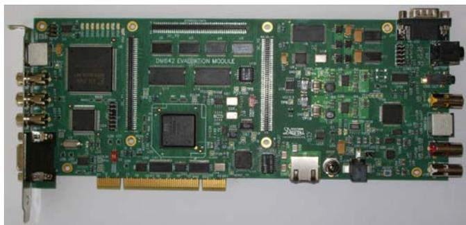
Рис. 6. Плата «TMS320DM642 evaluation module» фирмы Spectrum Digital
