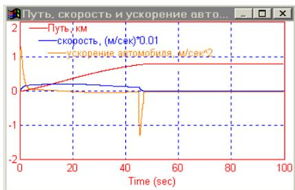
Рис. 2. Автомобиль тормозит на 46 секунде. Вторая производная координаты автомобиля изменяется скачком
