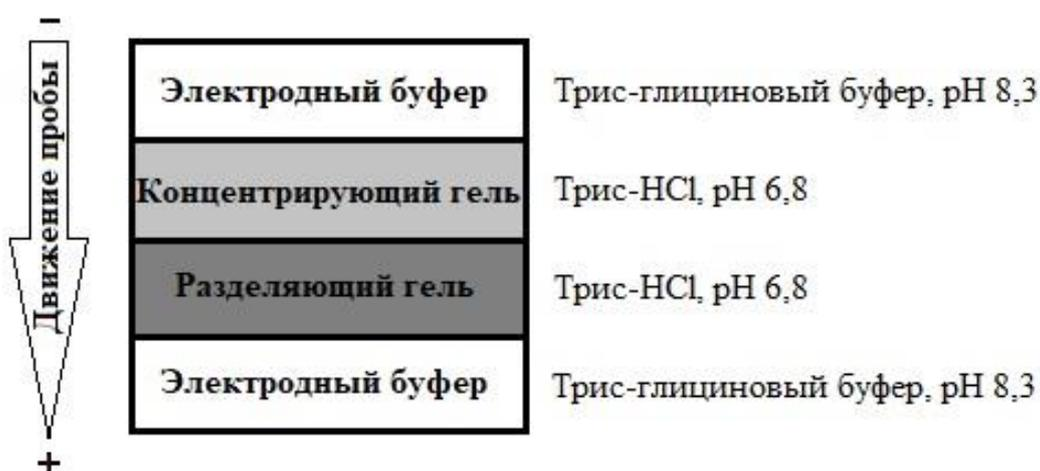
Рис. 18. Вариант прерывистой системы буферов для двухслойной схемы диск-электрофореза [65, с. 16]
