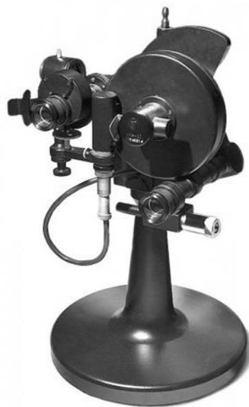
Рис. 114. Рефрактометр ИРФ-23 (типа Пульфриха)
