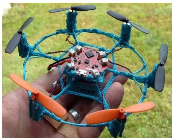
Рис. 1.10. Каркас дрона, собранный 3D-ручкой
