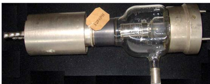
Рис. 1.4. М. А. Бонч-Бруевич (1888 – 1940) и генераторный триод коротковолнового диапазона с выходной мощностью 1 кВт и водяным охлаждением (1920-е годы)
