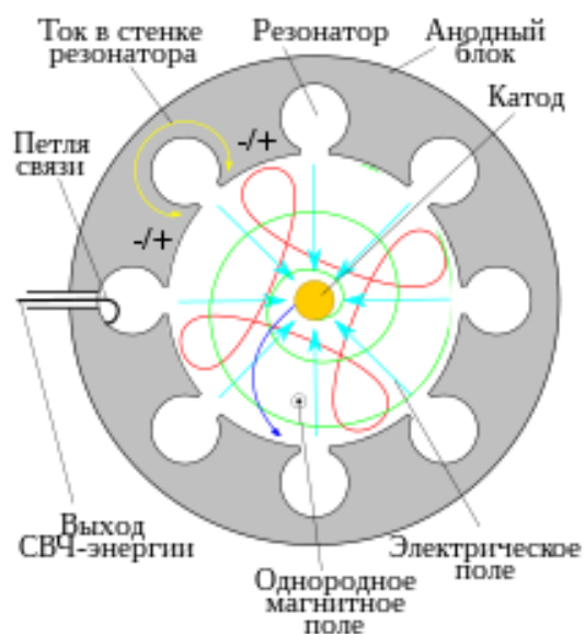
Рис. 1.26. Схема работы магнетрона
