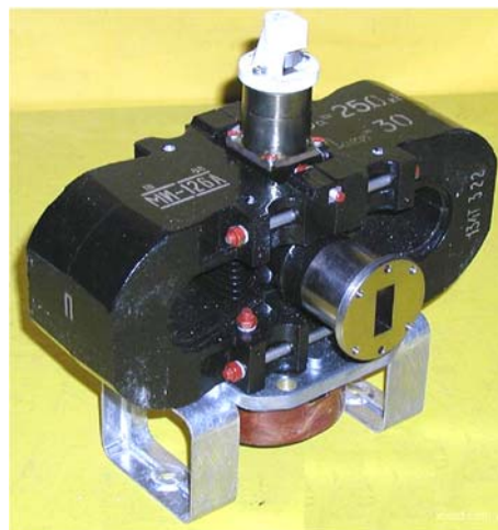
Рис. 1.25. Мощный магнетрон бортового радиолокатора
