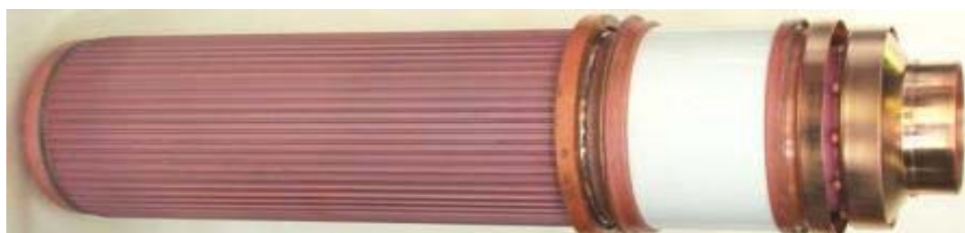
Рис. 1.5. Триод ГУ-88А мощностью 500 кВт на частоты до 32 МГц
