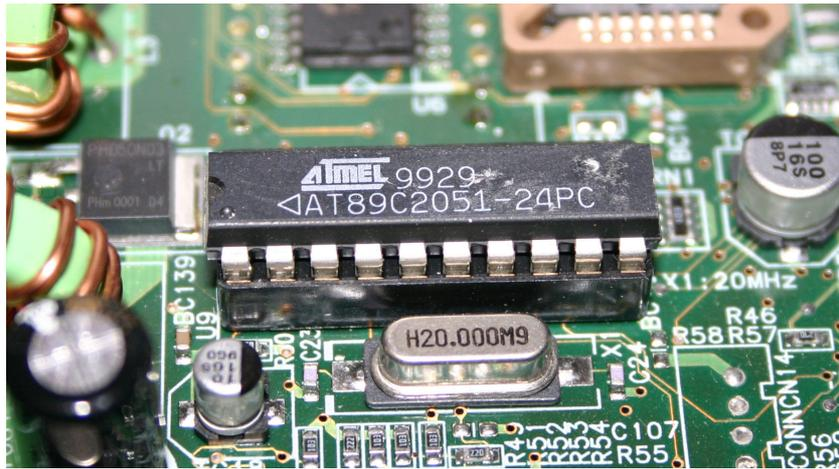
Рис. 1.4. Микроконтроллер на плате бытовой техники
