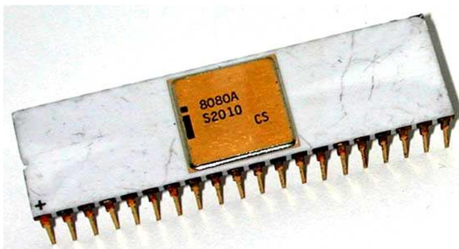
Рис. 1.11. 8-битный микропроцессор Intel 8080
