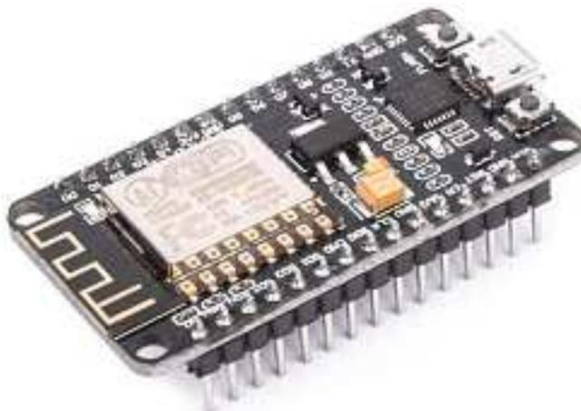
Рис. 1.30. NodeMCU (ESP8266)
