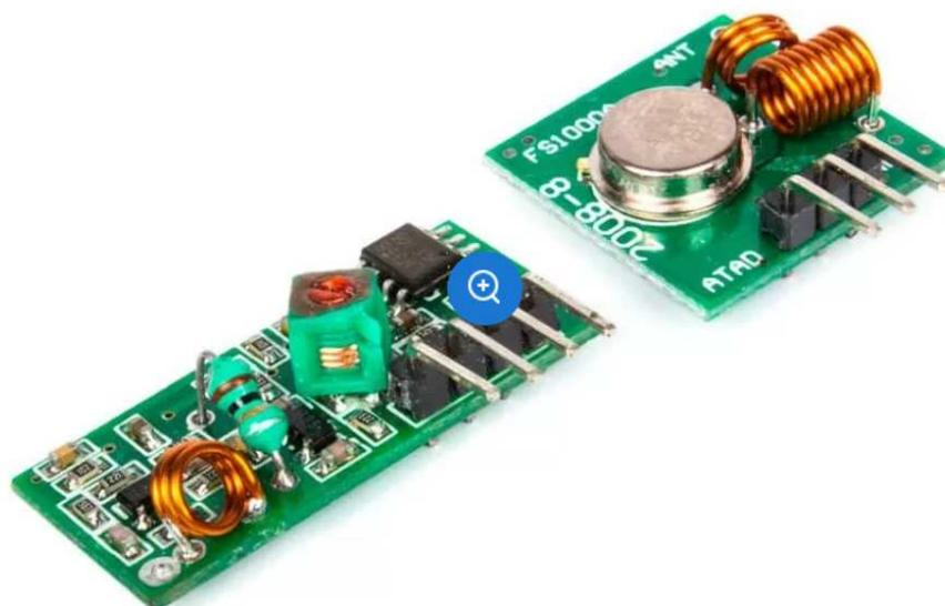
Рис. 3.5. Внешний вид беспроводного передатчика FS1000A и приемника MX-RM-5V
