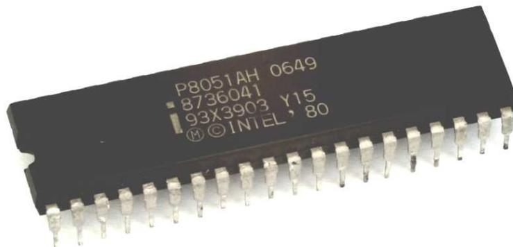
Рис. 1.13. Микроконтроллер второго поколения Intel 8051
