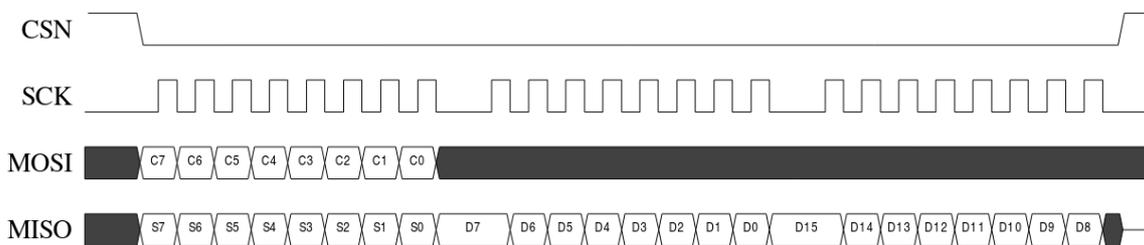
Рис. 3.10. Датаграмма операции чтения через интерфейс SPI
