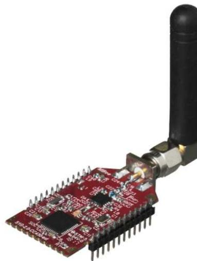
Рис. 3.6. Внешний вид радиомодуля MБee
