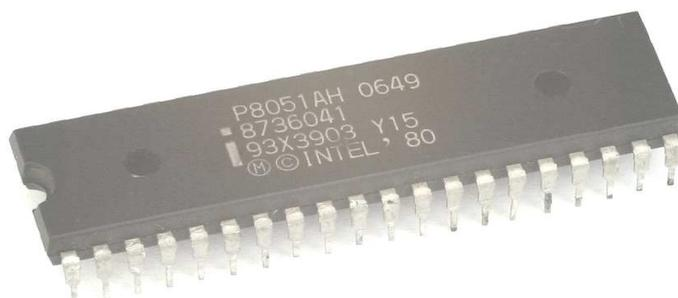
Рис. 1.8. Микроконтроллер i8051
