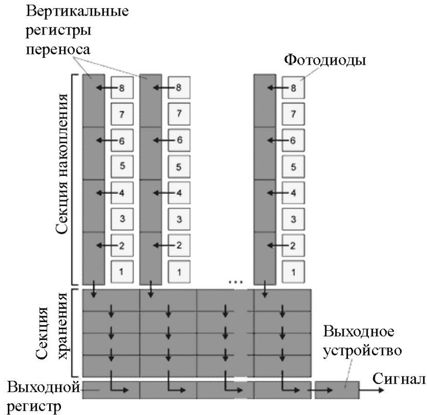
Рис. 2.8. ПЗС со строчно-кадровым переносом
