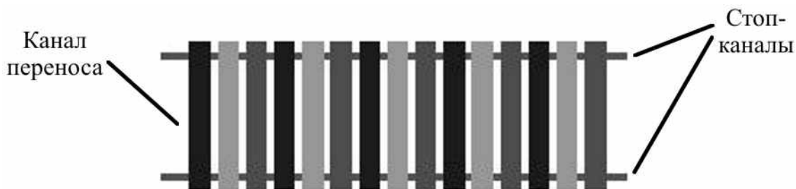
Рис. 2.4. Схема ограничения переноса заряда в боковом направлении стоп-каналами
