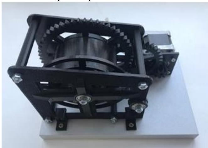
Рис. 2. Станок для переработки пластиковых бутылок в филамент для 3D принтера»
