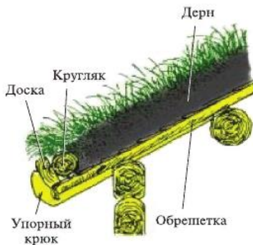
Рис. 2. Конструкция кровли
