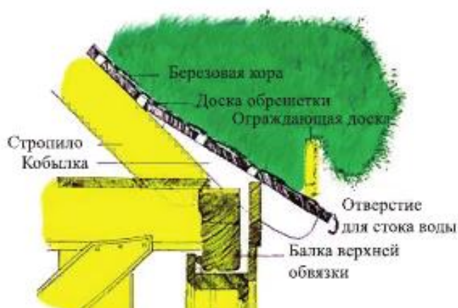
Рис. 1. Устройство крыши с дерновым покрытием
