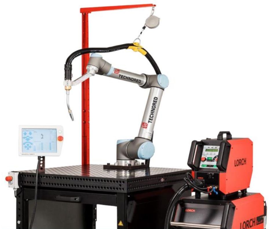
Рис. 2. Вид сварочного комплекса на базе робота Universal Robotics UR5
