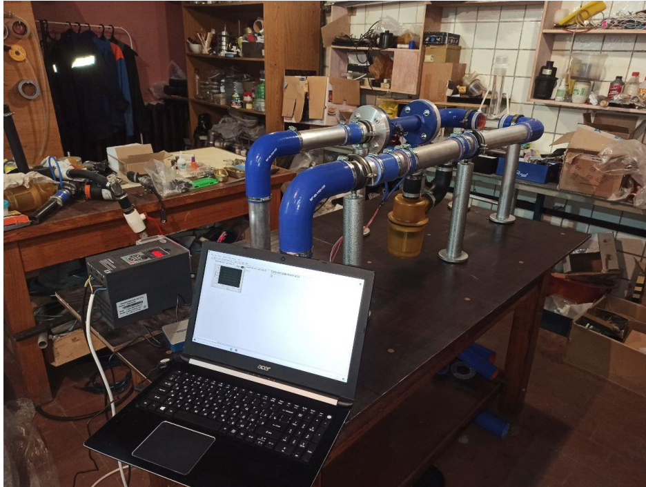
Рис. 2. Общий вид лабораторной установки для исследования устройств очистки ОЖ
