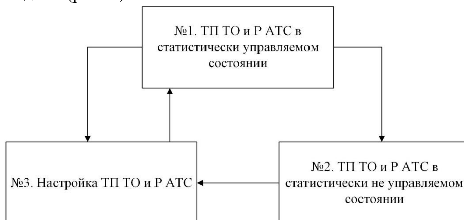
Рис. 1. Схема состояний и переходов ТП ТО и Р АТС одной технологической операции с учетом статистического управления качеством
