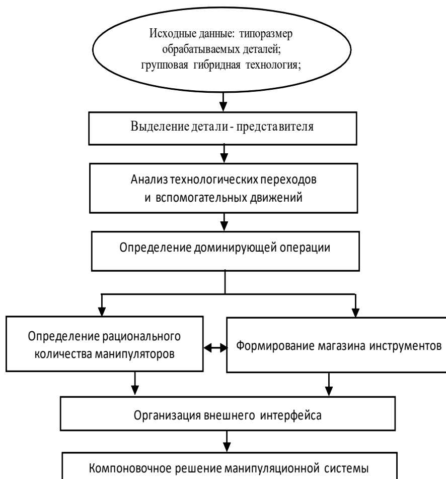
Рис. 1. Последовательность функционального комплексирования манипуляционной исполнительской системы для выполнения гибридных операций в производстве
