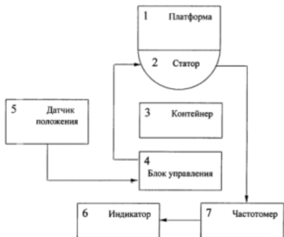
Рис. 1.11. Функциональная схема устройства для измерения массы в невесомости
