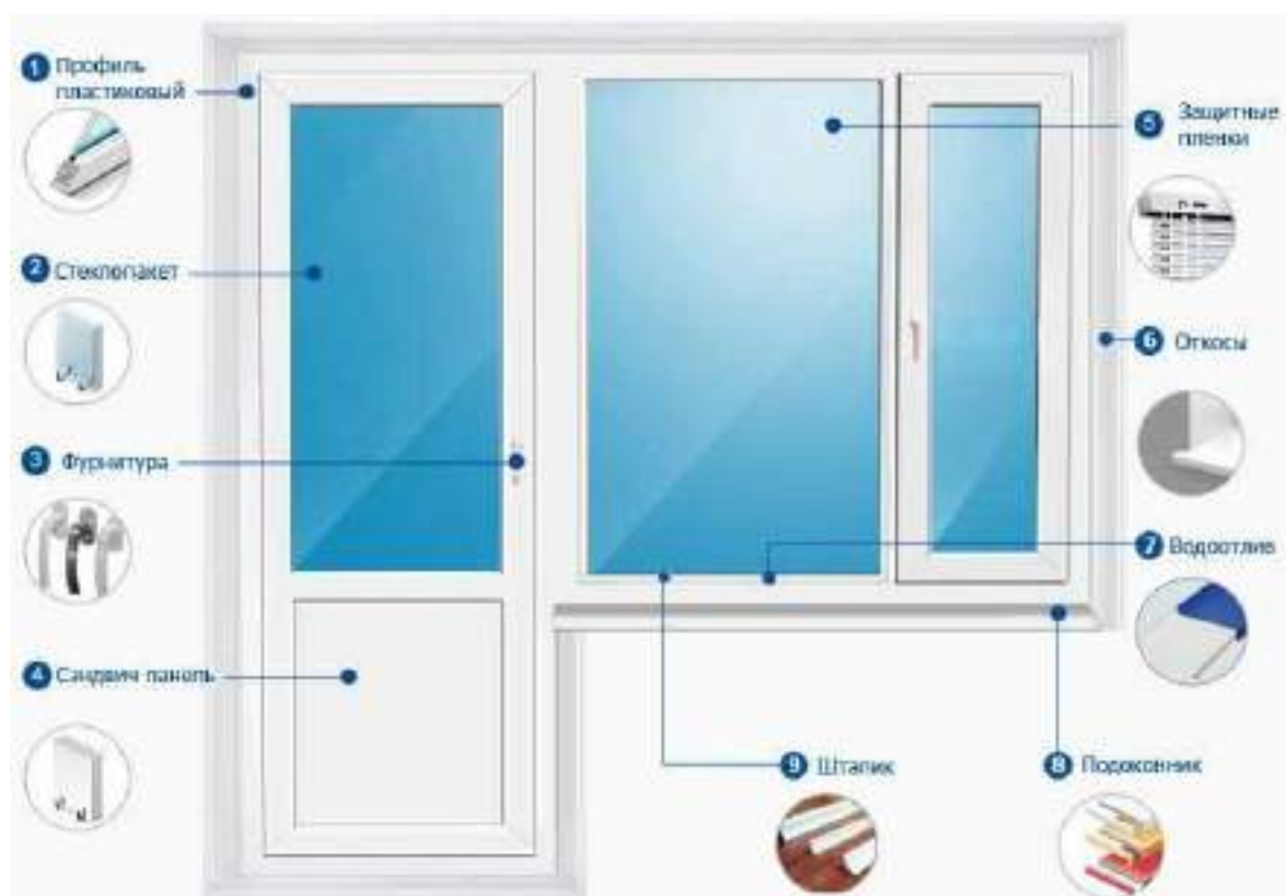
Рисунок 1 - Устройство окна из ПВХ.
