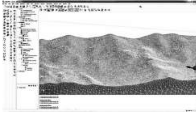
Рисунок 2. Компьютерная модель фрагмента земной поверхности, включающего трассу.
