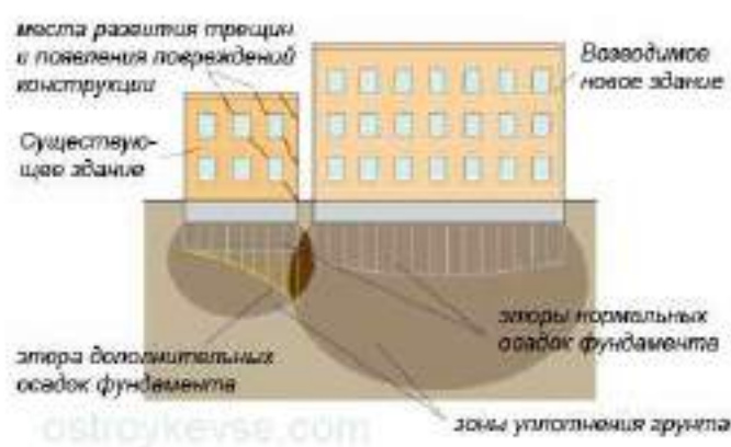
Рисунок 5 – Деформации при возведении нового здания возле существующего Аналогичные деформации сдвига могут наблюдаться и в случае возведения зданий в несколько очередей или при надстройке дополнительных этажей.
