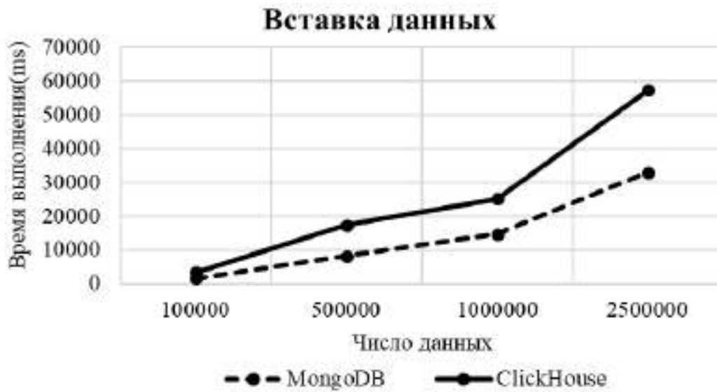
Рисунок 1 – Производительность операции вставки данных
