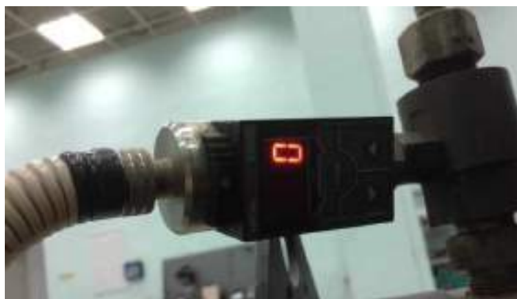
Рисунок 2 – Датчик давления рабочей жидкости в гидроцилиндре
