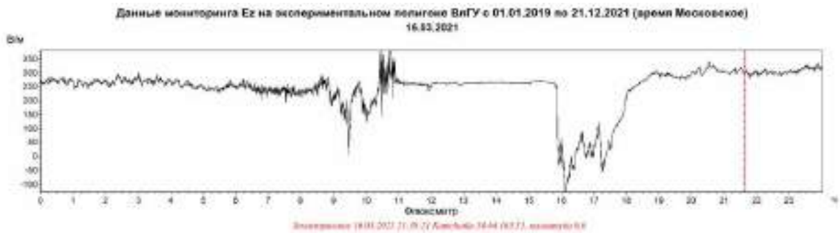
Рисунок 2– Данные мониторинга Ez за 16.03.2021 в момент землетрясения на Камчатке 54.64 163.35в 21:38:21 Магнитуда 6.6.
