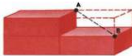
Рисунок 4 – Способ измерения искомой диагонали
