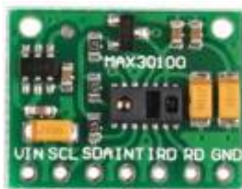
Рисунок 2 – Внешний вид датчика MAX30100.
