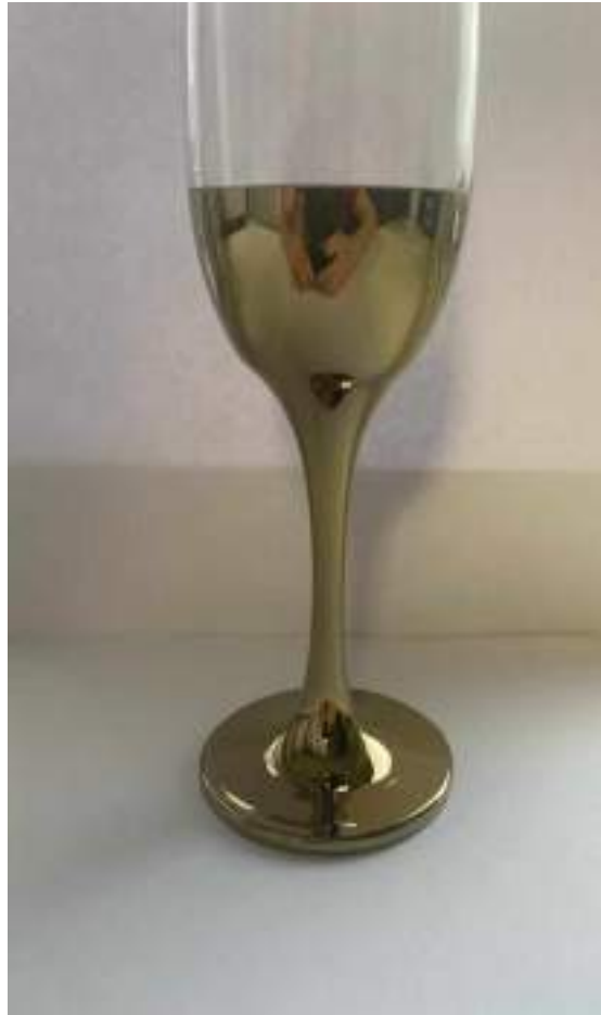
Рисунок 5 – Покрытие из оксида титана на стекле, нанесенное с помощью УВН
