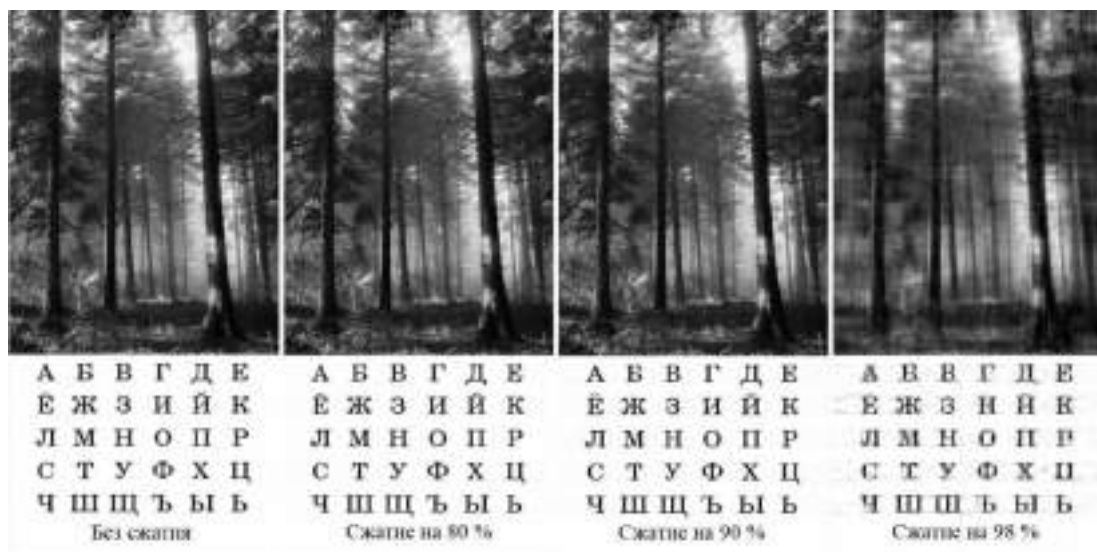
Рисунок 1 – Результат восстановления изображений, сжатых при помощи сингулярного разложения
