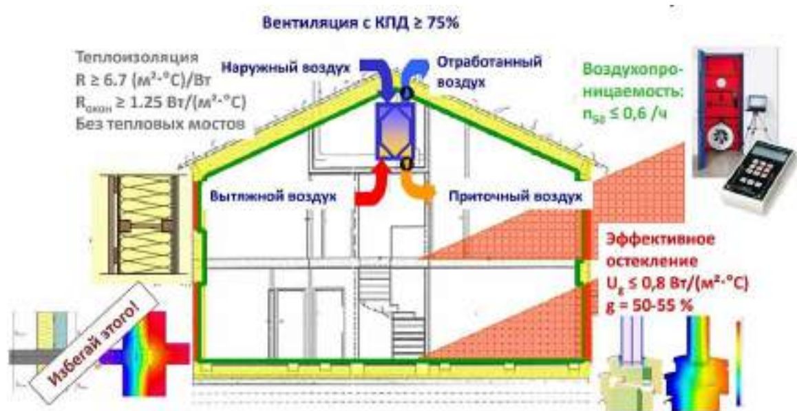
Рисунок 6 – Компоненты пассивного дома
