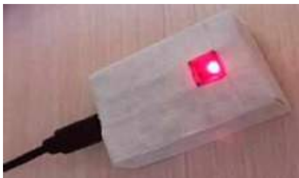
Рисунок 4 – Внешний вид блока регистрации фотоплетизмографического сигнала для контроля ортостатических нагрузок.
