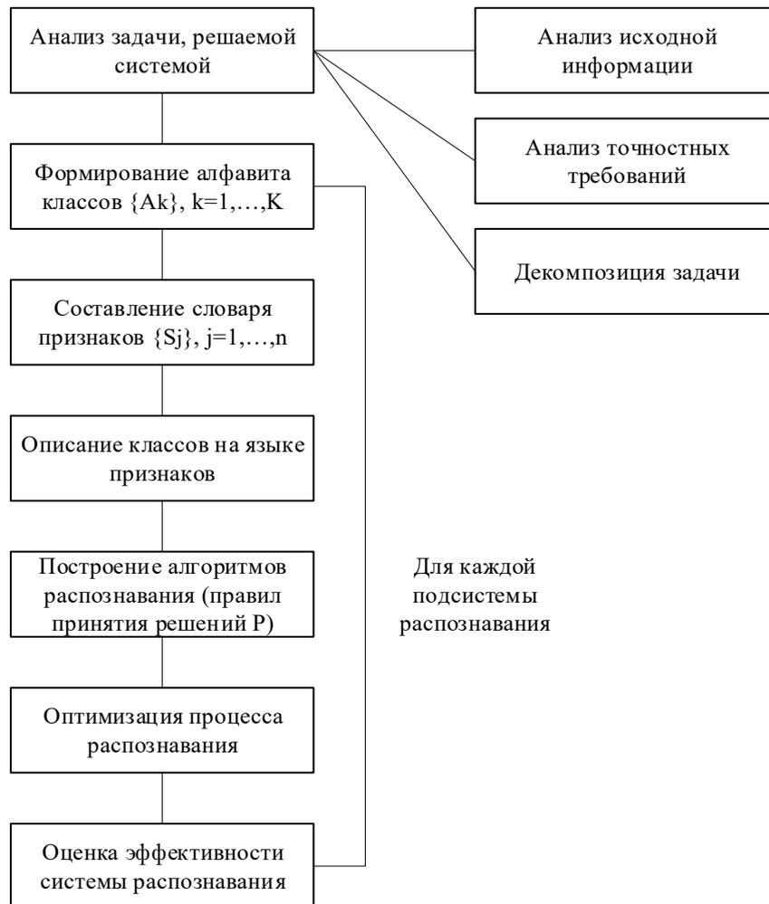
Рис. 1.2. Схема общего алгоритма системы распознавания
