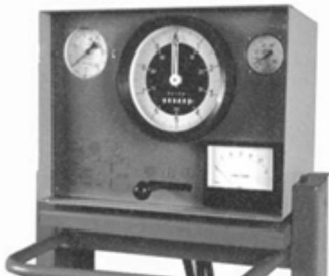
*Рис. 12.12. Установка для проверки гидросистем рулевого управления, мод. К-465М*
