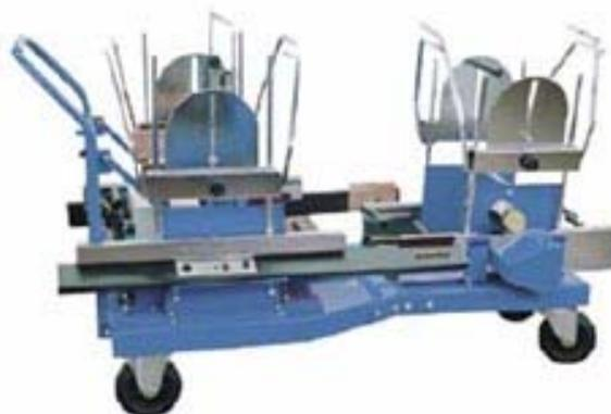
Рис. 8.10. Оптико-механический стенд Dynaliner 316 LKW
