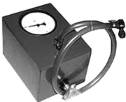
Рис. 11.12. Пневматический тестер регулятора ТНВД
