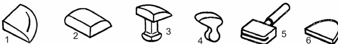
Рис. 13.3. Фасонные плиты, оправки, наковальни: 1 – плита для чистовой отделки поверхности лицевых деталей; 2 – плита для исправления вмятин; 3, 4 – наковальни для восстановления профиля деталей; 5 – оправка для исправления фланцев и желобов; 6 плита для отделки плоских поверхностей
