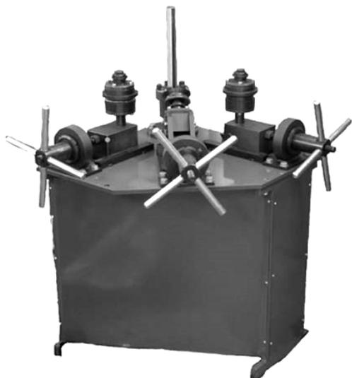
Рис. 10.5. Стенд для правки колесных дисков, мод P184M2
