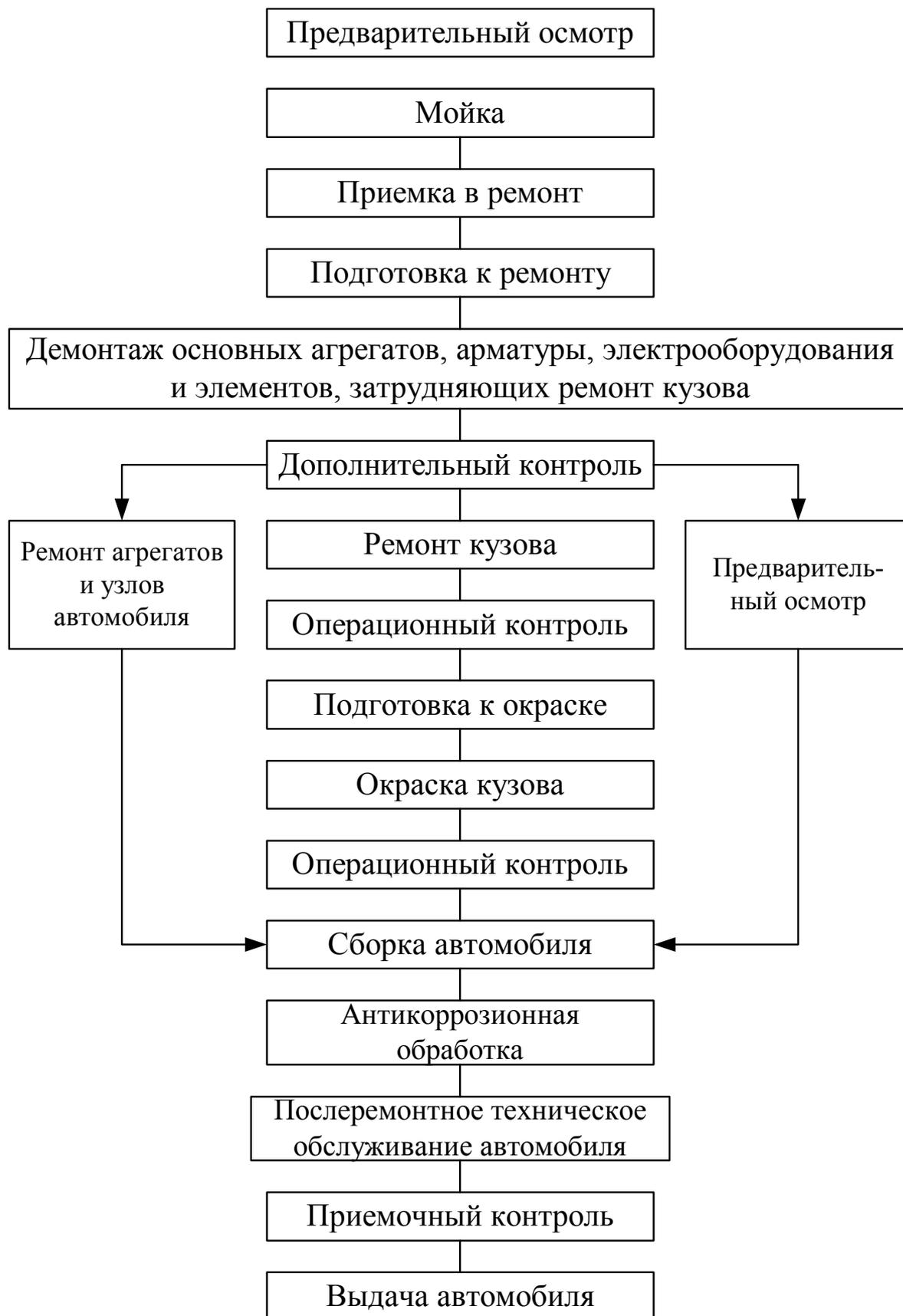
Рис. 13.1. Технологический процесс ремонта кузова легкового автомобиля
