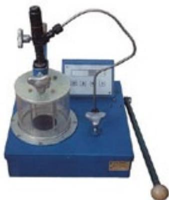
*Рис. 11.10. Стенд для испытания и регулировки форсунок дизельных двигателей*
