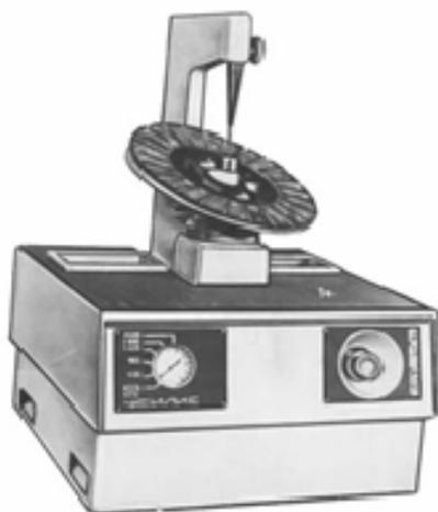
*Рис. 12.19. Пневмопресс для клепки тормозных накладок*
