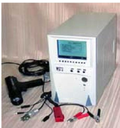
Рис. 7.4. Универсальный мотор-тестер МЗ-2
