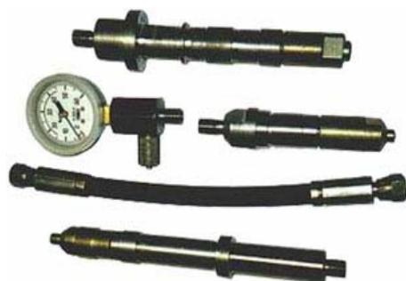
Рис. 7.12. Компрессометр KM-201
