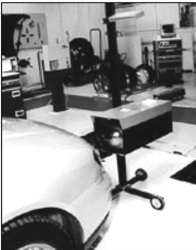
*Рис. 9.2. Прибор для проверки и регулировки света фар, мод. ОП*
