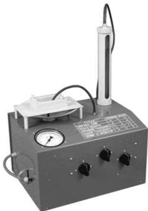
*Рис. 11.4. Прибор проверки карбюраторов ППК*
