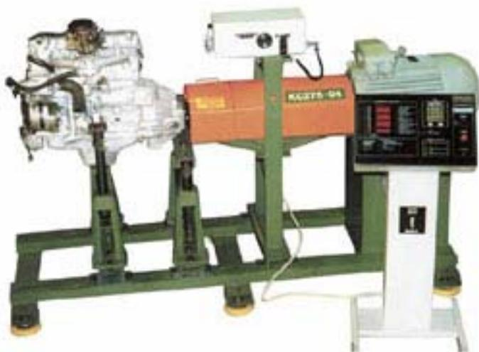
Рис. 12.27. Универсальный обкаточный стенд, мод. КС 276-03
