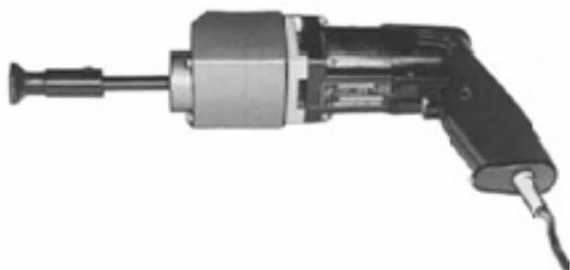
Рис. 12.25. Устройство для притирки клапанов, мод. Р 177
