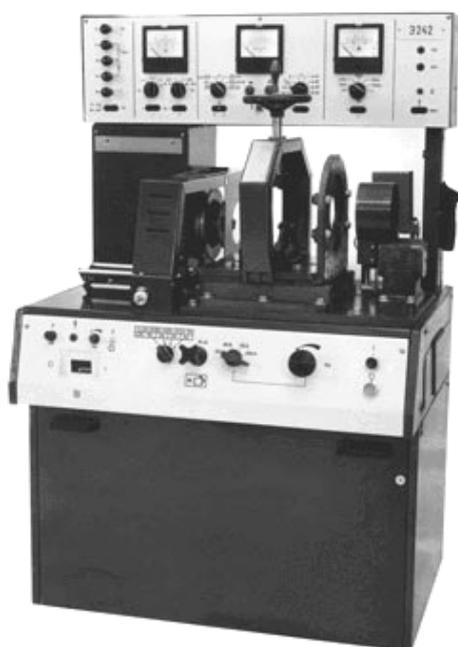
Рис. 11.2. Контрольно-испытательный стенд Э-242
