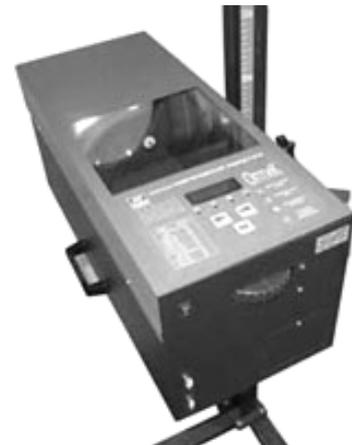
*Рис. 9.3. Прибор для проверки технического состояния и регулировки внешних световых приборов, мод. ОПК*
