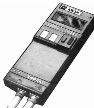
Рис. 6.1. Прибор «Эффект» для проверки эффективности тормозных систем
