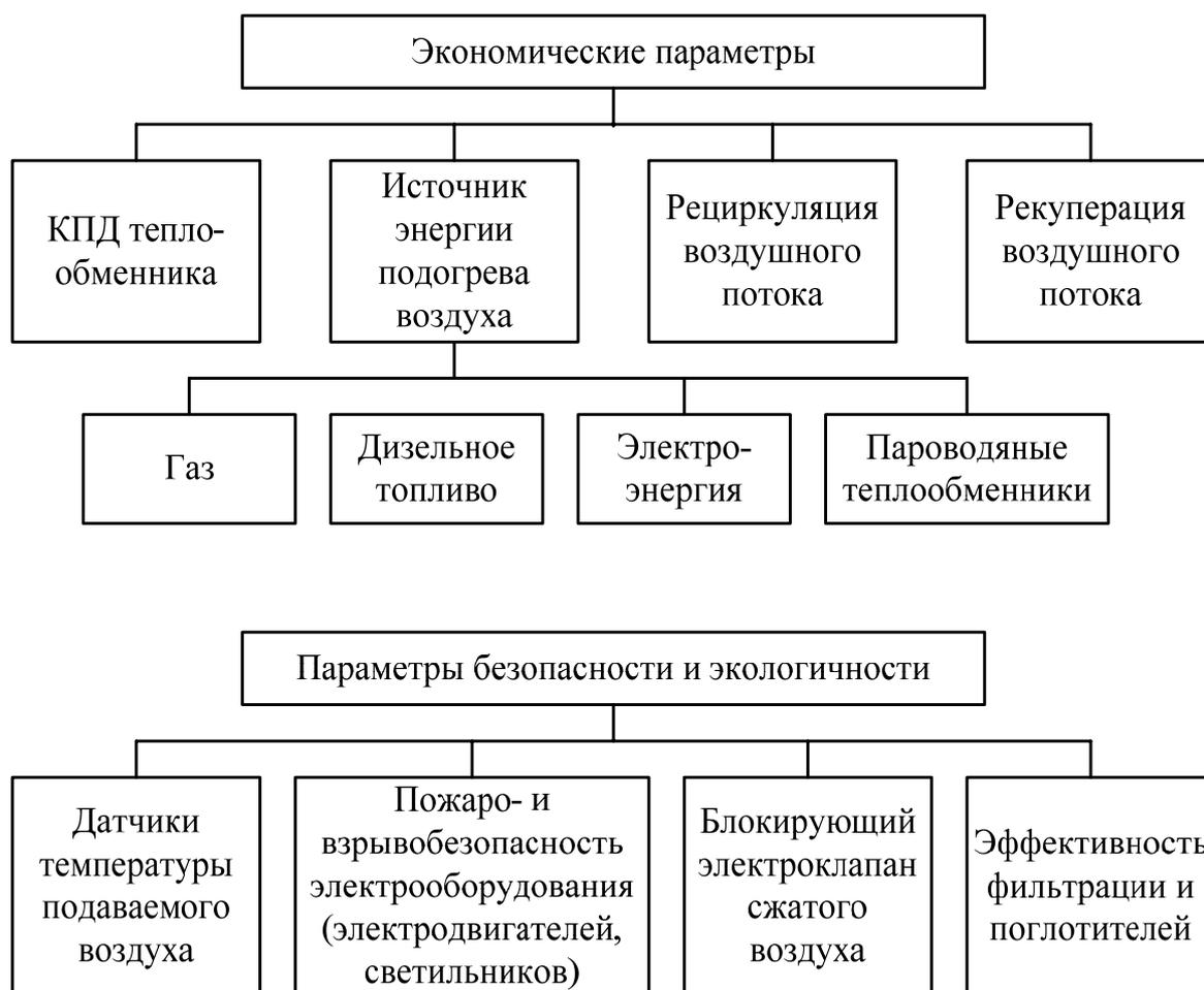
Рис. 14.7. Параметры окрасочно-сушильных камер
