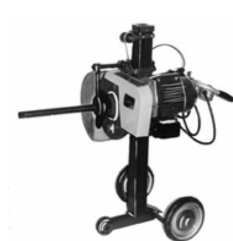
*Рис. 12.10. Гайковерт для гаек колес, мод. И-330*
