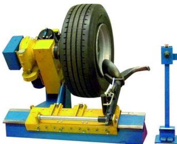
Рис. 10.2. Шиномонтажный станок, мод. ШМГ-1
