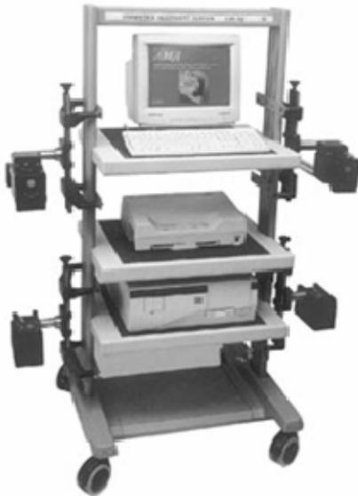
Рис. 8.9. Компьютерный стенд для контроля и регулировки колес КДСО
