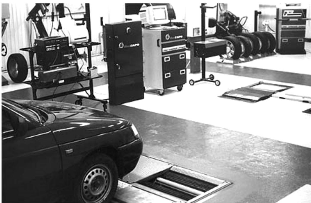
*Рис. 3.1. Стационарная линия технического контроля легковых автомобилей, микроавтобусов и мини-грузовиков с нагрузкой на ось до 3 т*
