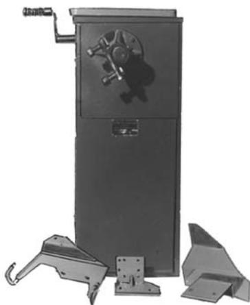
*Рис. 12.14. Стелд для разборки и сборки двигателей легковых автомобилей, мод. Р 621*
