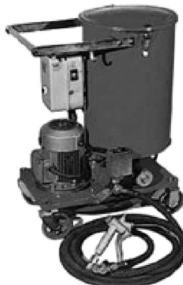
Рис. 3.11. Передвижной электрический солидолонагнетатель, мод. С321М
