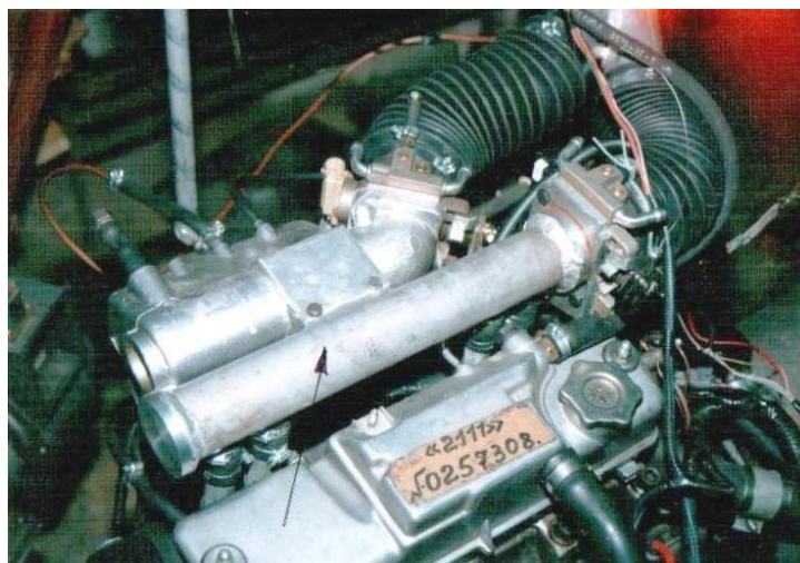
Рис.5.4. Внешний вид устройства для регулирования вихреобразования на впуске, установленного на двигателе ВАЗ-2111 (воздушная магистраль устройства показана стрелкой)
