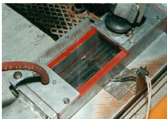
Рис. 3.13. Общий вид канала с нагретой поверхностью (чувствительным элементом термоанемометра)
