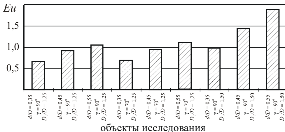
Рис. 4.14. Влияние угла наклона тангенциальных входных каналов ВК относительно горизонтальной оси на сопротивление камеры ( D=80 мм; \Phi=1,2 ; D_1/D = \text{var} )
